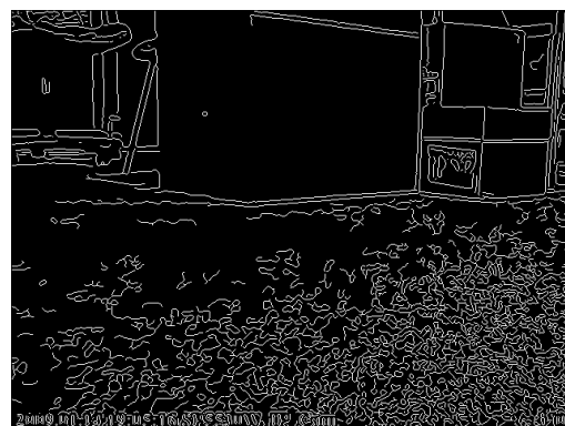
Fig. 5. Edge detection by Canny edge detector.
